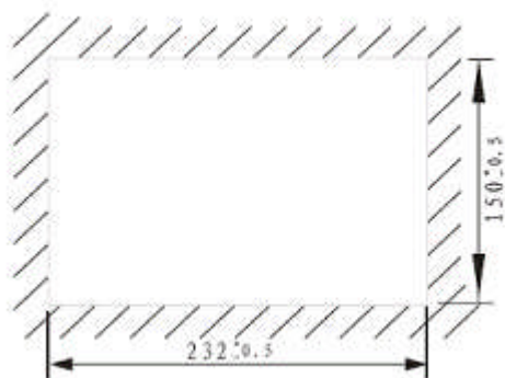
面板镶嵌式安装的面板切口尺寸
